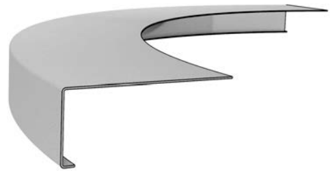
Bild 20 Simulation eines neuen gerundeten Profils mit 80 mm hohem Flansch (Visualisierung: RWTH Aachen University) Simulation of a new rounded profile with 80 mm high flange
