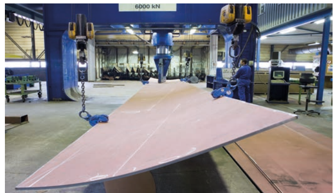
Bild 5 Inkrementelle Umformung großer Stahlplatten in Schiffsbau-Portal-Pressen (Foto: CIG Architecture) Incremental forming of large steel plates in shipbuilding gantry press
